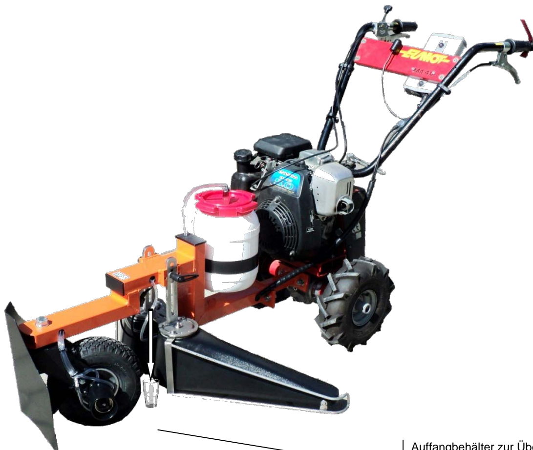
Auffangbehälter zur Überprüfung der Ausbringmenge
