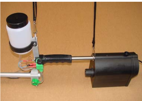
7. Monter la sangle sur le réservoir et le support du Powerpack
