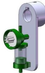
Steht das Dosierventil auf spülen ist die Durchflussmenge so groß, dass die Düse überläuft.
