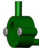
Staut sich das Präparat am Filter, muss dieser gereinigt werden. Lösen Sie die Schrauben und spülen das Sieb
