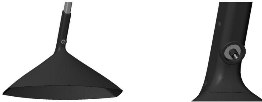
Lösen Sie die Schraube der Wählscheibe sowie die darunter liegenden Schrauben und spülen die Bauteile mit warmen Wasser
